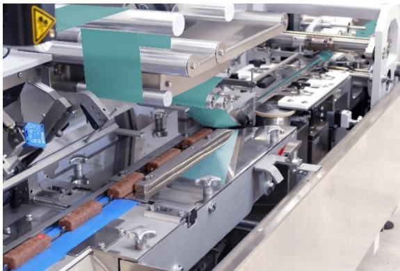
Bild 1: Theegarten-Pactec hat die FPC5 – eine modulare Hochleistungs-Verpackungsmaschine für Riegel- und Tafelprodukte in Schlauchbeutel – so weiterentwickelt, dass sie papierbasierte Packmittel und recyclebare Monofolien verarbeiten kann.
