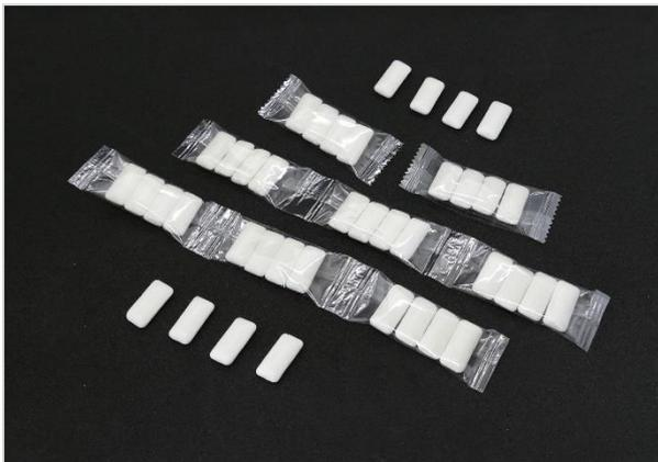
Bild 2: Ein Vorteil der FPH5 ist ihre hohe Flexibilität. Je nach Kundenanforderung ist mit ihr eine Aufteilung von 2, 3 oder 4 Produkten pro Verpackung möglich. Zudem lässt sich die Umstellung zwischen den einzelnen Packungsgrößen besonders schnell realisieren.
