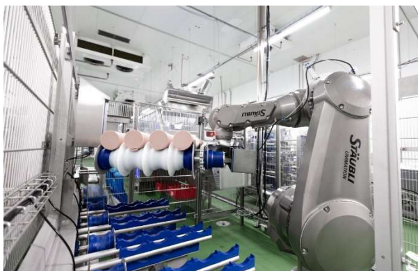
Bei Kaufland Fleischwaren übernimmt seit kurzem ein TX200 HE die Beladung einer automatischen Schneide- und Verpackungsmaschine.
