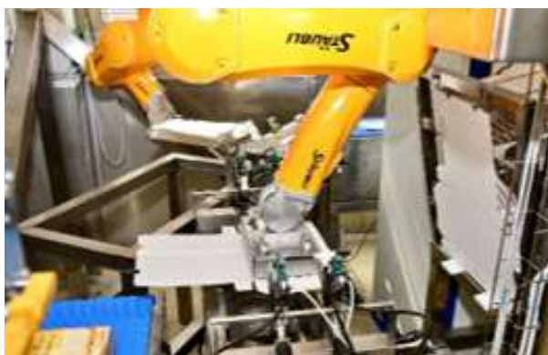
Bei der Weinbergmaier GmbH in Wien verpacken zwei Stäubli Sechssachser hochwertigen Strudelteig.
