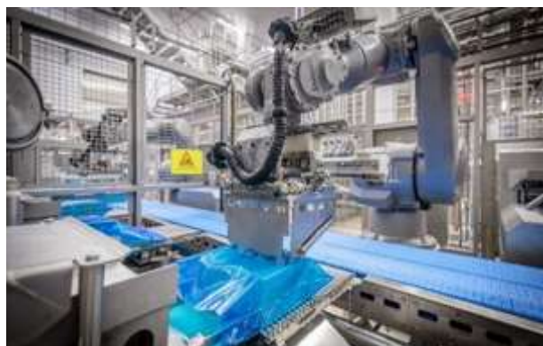
In der Hartkäseproduktion bei BMI Bayerische Milchindustrie eG übernehmen Stäubli HE-Roboter die Primärverpackung der frisch produzierten Käseblöcke.
