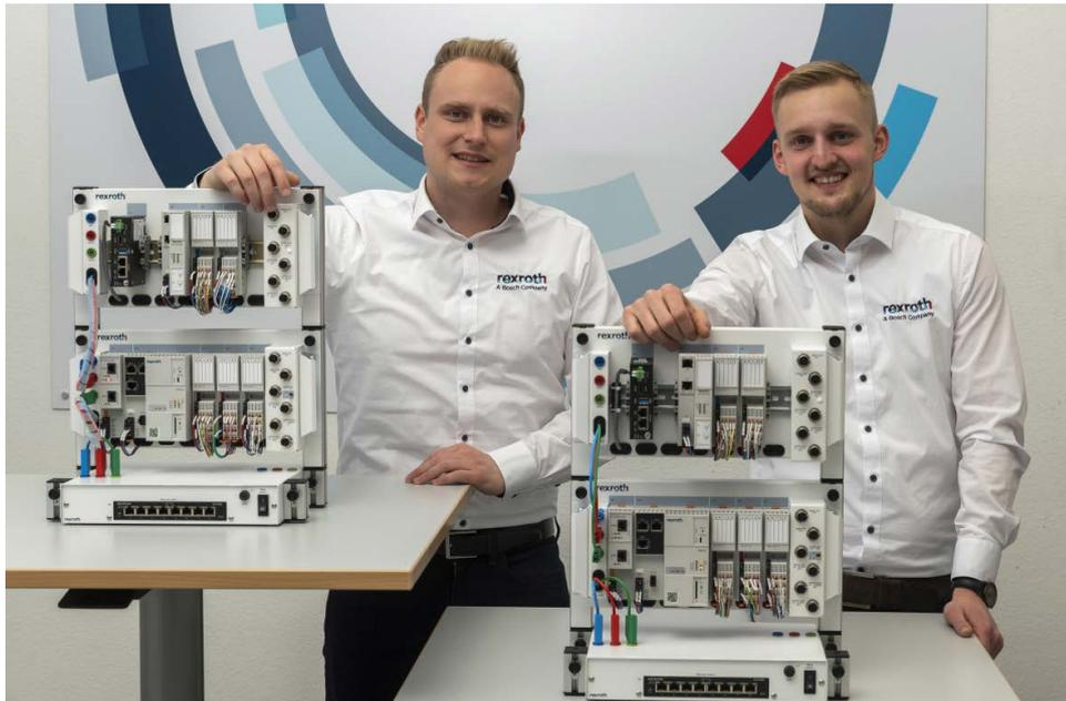
Das neue Trainingssystem XITE Automax 102 von Bosch Rexroth basiert auf aktuellen Serienkomponenten für die Automatisierung und vermittelt die notwendigen Kenntnisse für eine vernetzte Produktion und eine nachhaltige Steigerung der Energieeffizienz. (Bildquelle: Bosch Rexroth AG)
