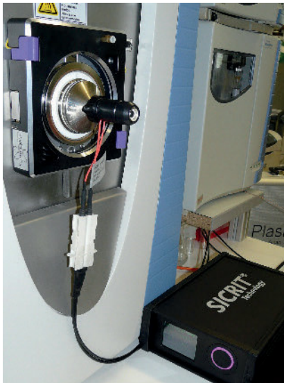
Abb. 2. Die Sicrit-Quelle wird direkt am Einlass eines LC-MS-Systems installiert, hier an einem Orbitrap-System von Thermo Fisher (links). Direkte Messung der Röstaromen einer im heißen Gasstrom erhitzten Kaffeebohne mit der Sicrit-Ionenquelle (rechts).
